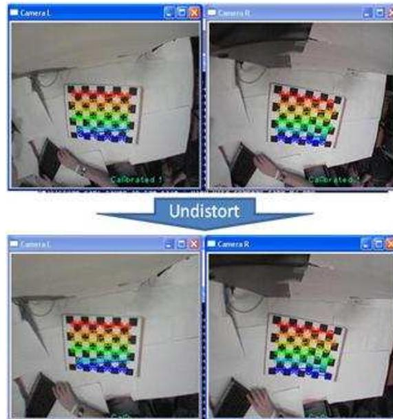
Figure 17 - Correction de la distorsion optique
